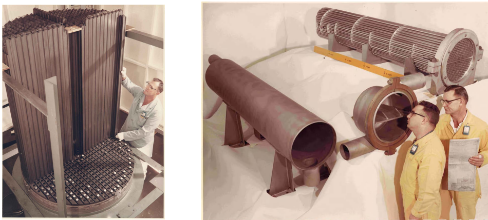
FIGURE 1.12: A gauche : la structure du cœur en graphite du réacteur du MSRE, à droite : les échangeurs de chaleur
