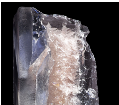
FIGURE 2.2: A gauche : sel LiF à l'état solide massif (photographie fournie par Véronique Ghetta, LPSC), à droite : sel fondu (FLi-NaF-KF) à 500°C (photographie fournie par Sylvie Delpech, IPNO)
