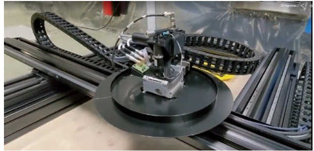
Figure 2. Photographie du banc d'étalonnage optique faisceau fin de la caméra du Rubin LSST (crédit : LPSC).
