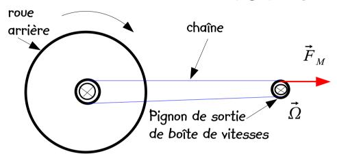
Puissance délivrée par le moteur sur le pignon de sortie de boîte de vitesses
