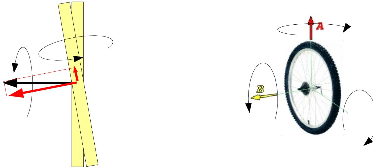
On tourne la roue vers la gauche en appliquant un petit moment perpendiculaire à l'axe de rotation de la roue. Le moment cinétique initial se conserve. Il induit alors une projection (en rouge) sur un axe perpendiculaire à l'axe de rotation de la roue qui fait basculer la roue vers la droite.
